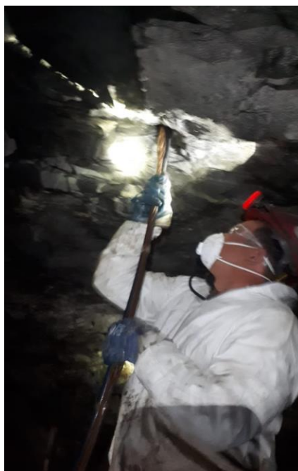
2.16 Сурет – Бұрғыланған ұңғымаға ұзындығы 200 мм-ге жуық тростық анкерді енгізу көрінісі
